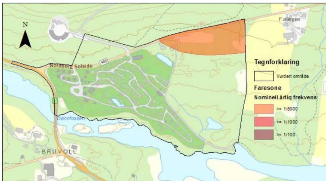
Kartfigur 5: Faresonekart for NGIs kartlegging i 2016 av skredfare i samband med reguleringsplanen for Dønfoss camping. Arealet med oransje farge er areal der nominell fare for skred er 1/5000.
