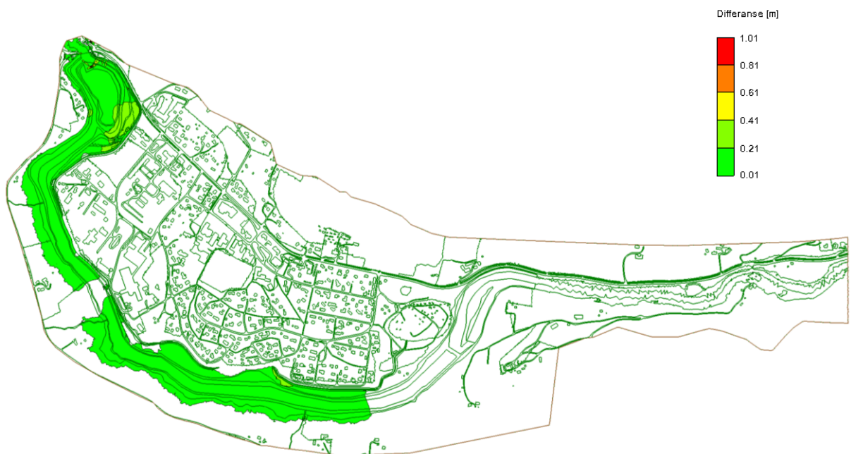
Figur 2.7: Vannstandsstigninger i planlagt tilstand
