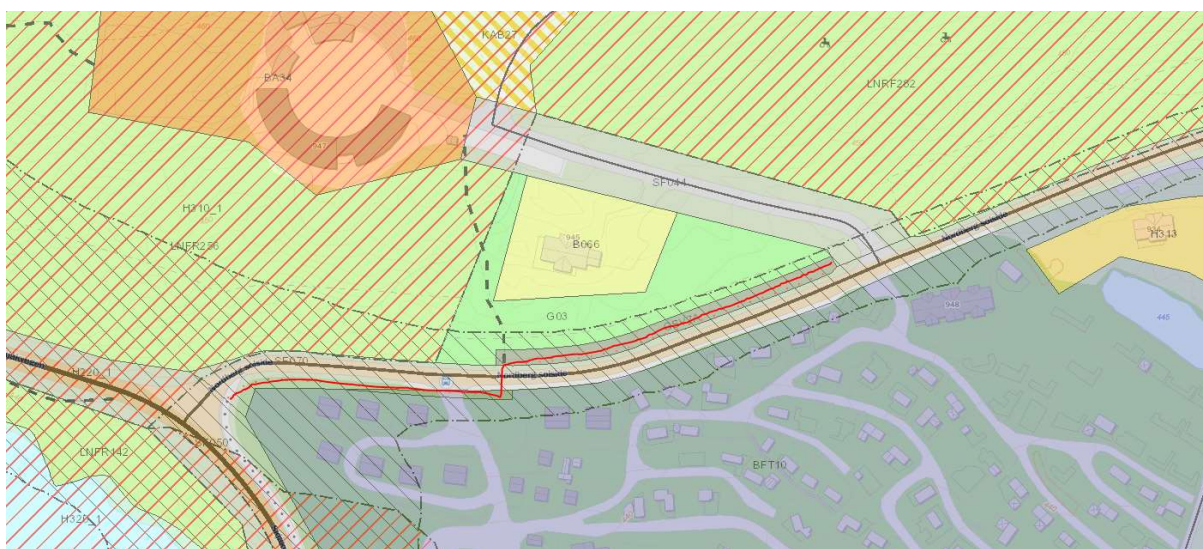
Figur 6. Kommunepanens arealdel med underliggende grunnlagsdata (FKB). Framtidig gang- og sykkelveg er framhevet med rød linje.
